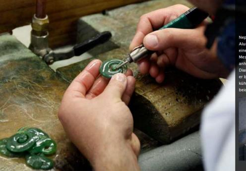
Nephrite Jade besteht hauptsächlich aus Aluminium, Magnesium und Kieselerde – eine extrem feste Verbindung. Selbst ein Messer kann richtigem Jade nichts anhaben. Nur mit den noch härteren Diamantwerkzeugen und viel Geduld kann er bearbeitet werden. Ein Wasserstrahl kühlt Werkzeuge und Stein und bewahrt beide vor Überhitzung.
